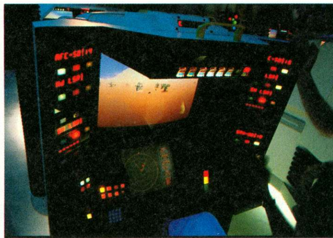
Cockpit: 60 Schalter, 2 Screens, 2 Joysticks und 2 Pedale
